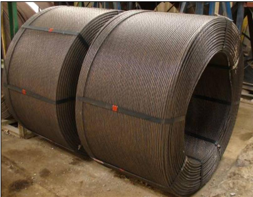
Abbildung 3-4 Spannstahlrollen im Werk BRESPA
