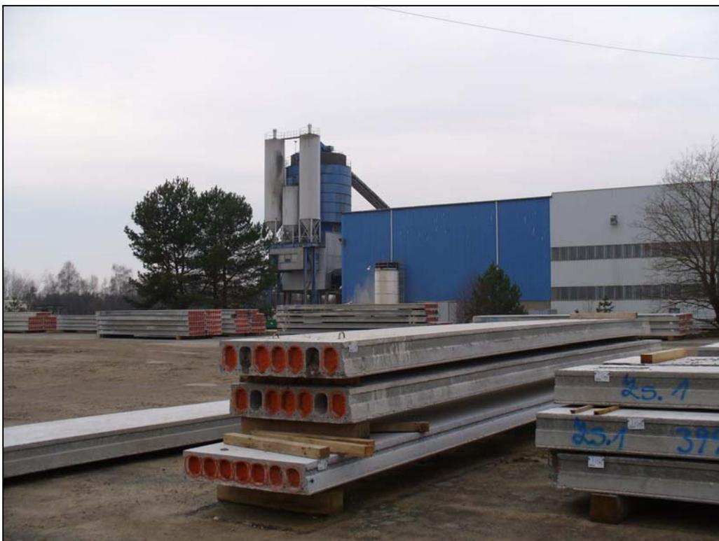
Abbildung 3-5 Die fertig produzierten Spannbeton-Fertigdecken mit Abdeckkappen (orange) lagern auf dem Lagerplatz innerhalb des Werksgeländes bevor sie auf die Baustelle transportiert werden. Foto aufgenommen am 20.02.2008 bei der Werkbesichtigung in Schneverdingen
