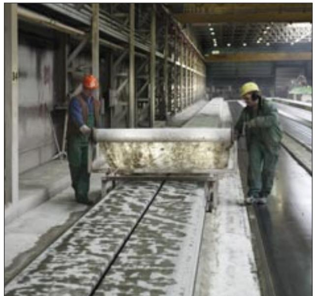
Bild 14+15: Nachbehandlung der frisch fertiggestellten Spannbetonfertigdecken
