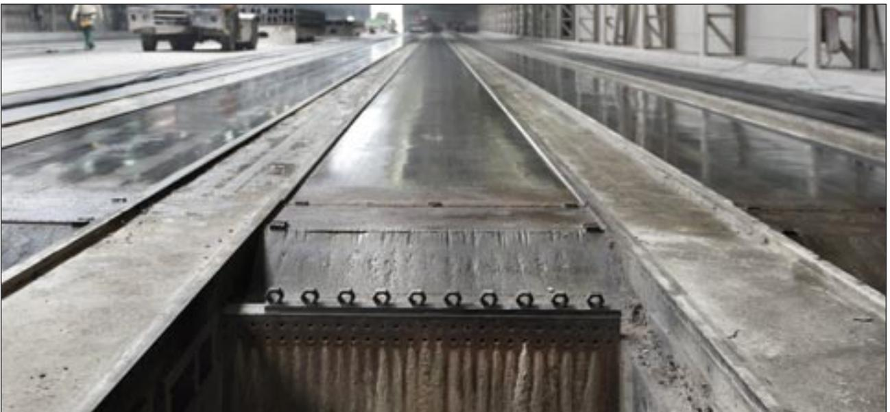
Bild 2: Die vollständig gereinigte und geölte Bahn ist nun vorbereitet für den Produktionsprozess
