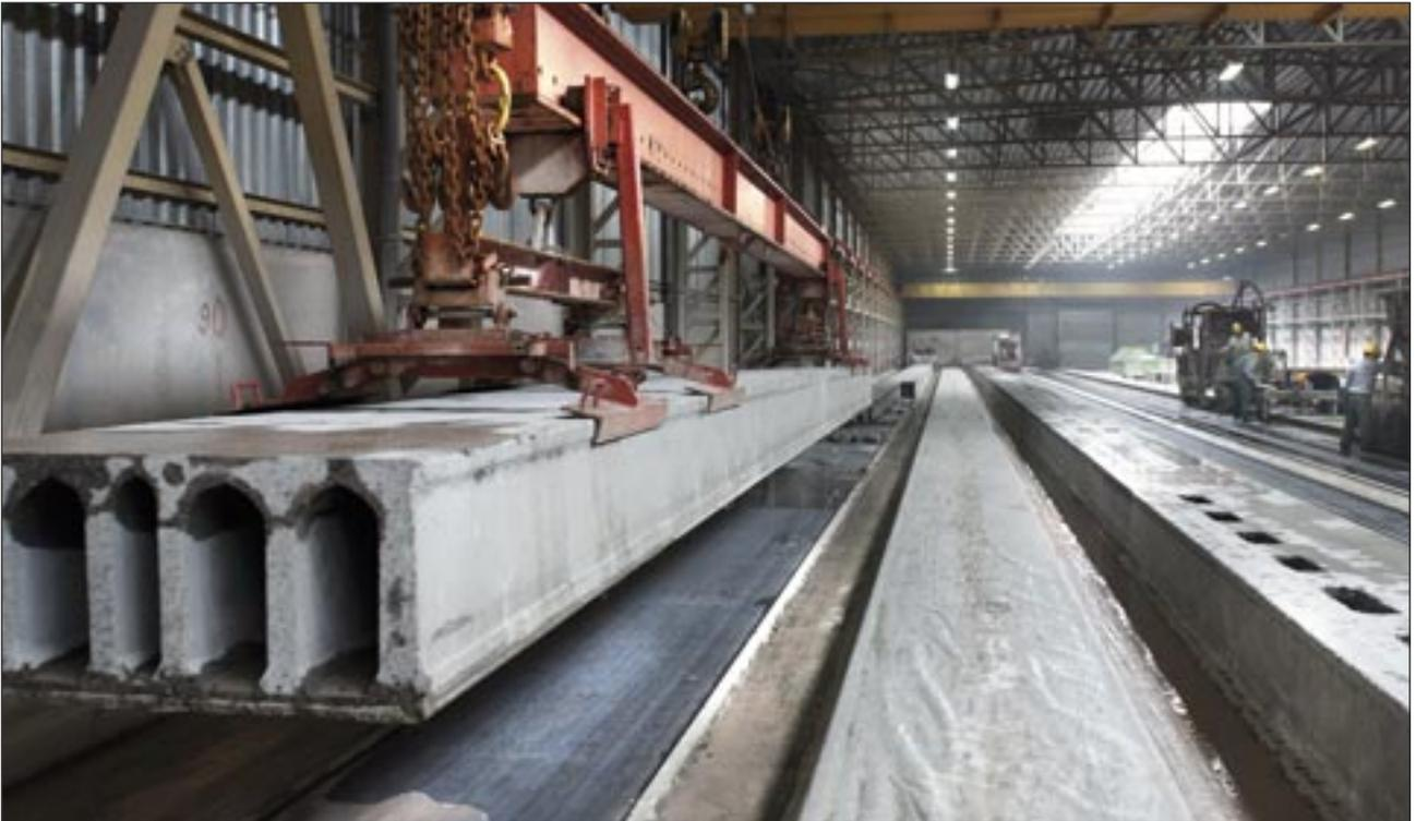
Bild 18: Abhebeprozess von den Fertigungsbahnen
