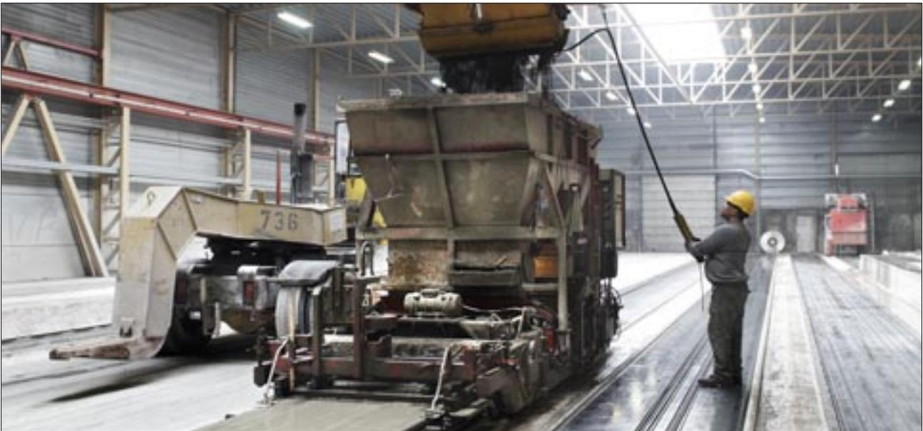
Bild 6: Während des Betoniervorgangs auf der Bahn wird der Fertiger regelmäßig mit Beton beschickt
