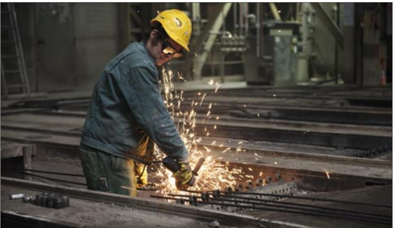
Bild 17: Abtrennen der einzelnen Spannstahlilitzen nach erfolgtem Produktionsprozess
