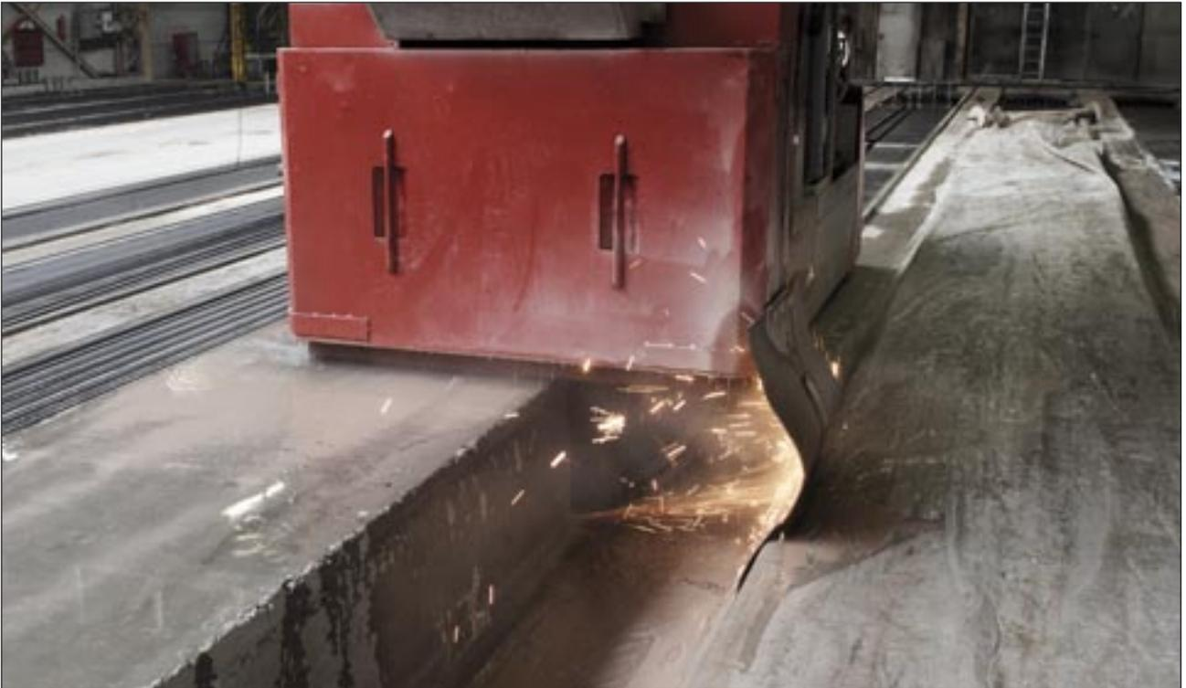
Bild 16: Einsatz der Betonsäge zur Elementabtrennung
