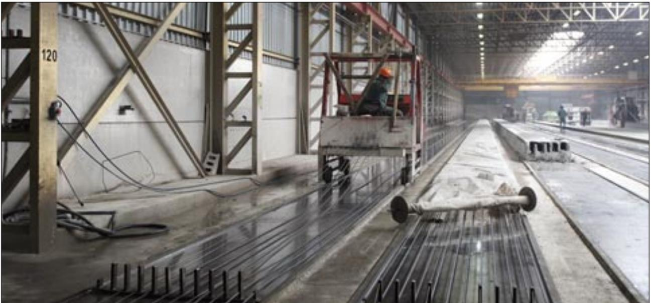
Bild 3: Drahtziehwagen beim Ausziehen der Spannstahlbewehrung
