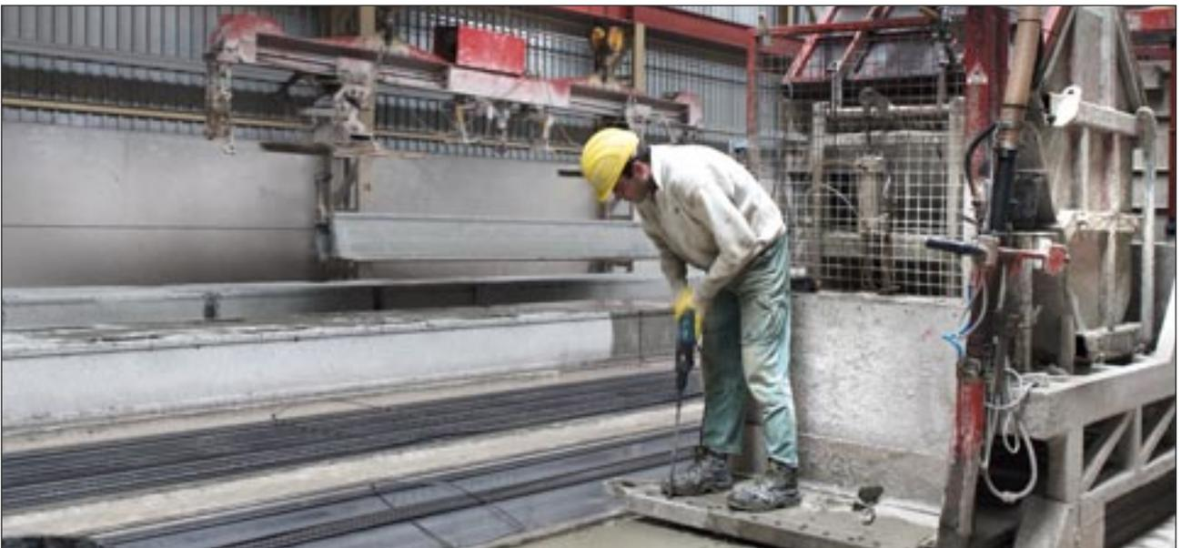
Bild 12: Herstellung der Entwässerungsöffnungen – unabdingbar in der Spannbetondeckenherstellung
