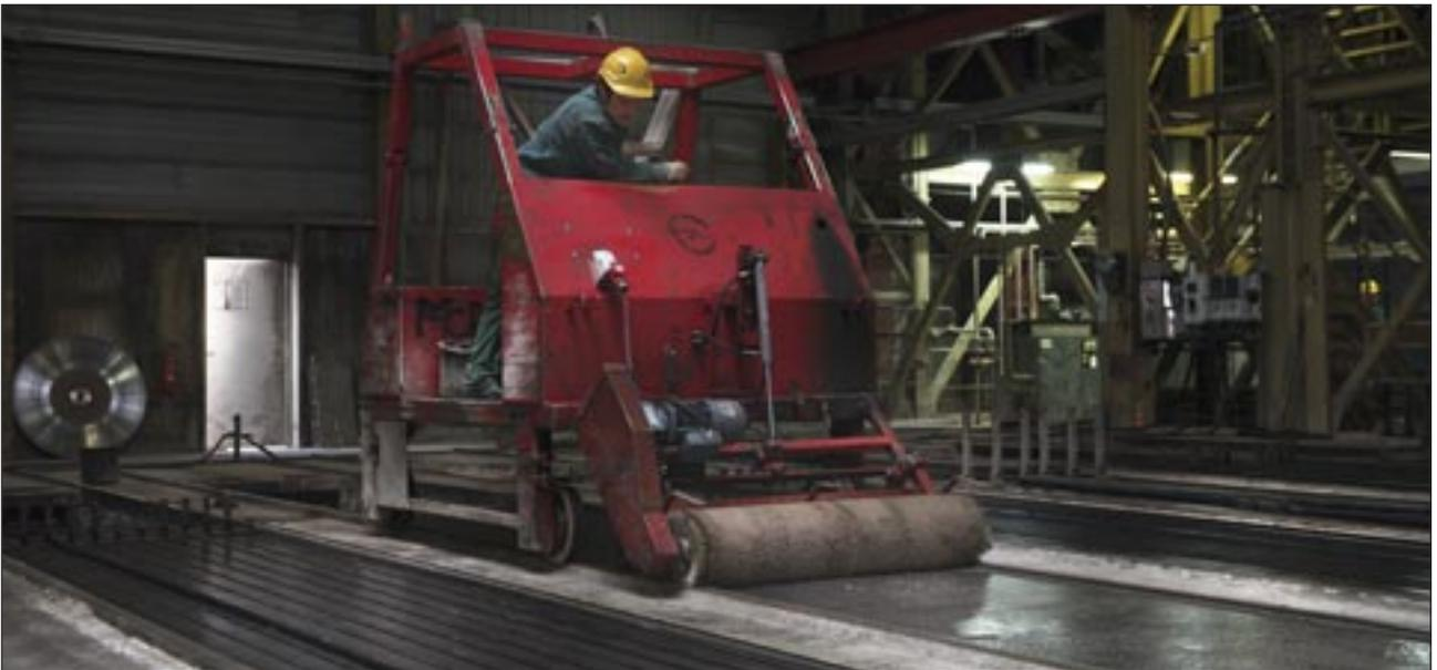
Bild 1: Vorbereitung der Fertigungsbahnen mit Reinigungsmaschine
