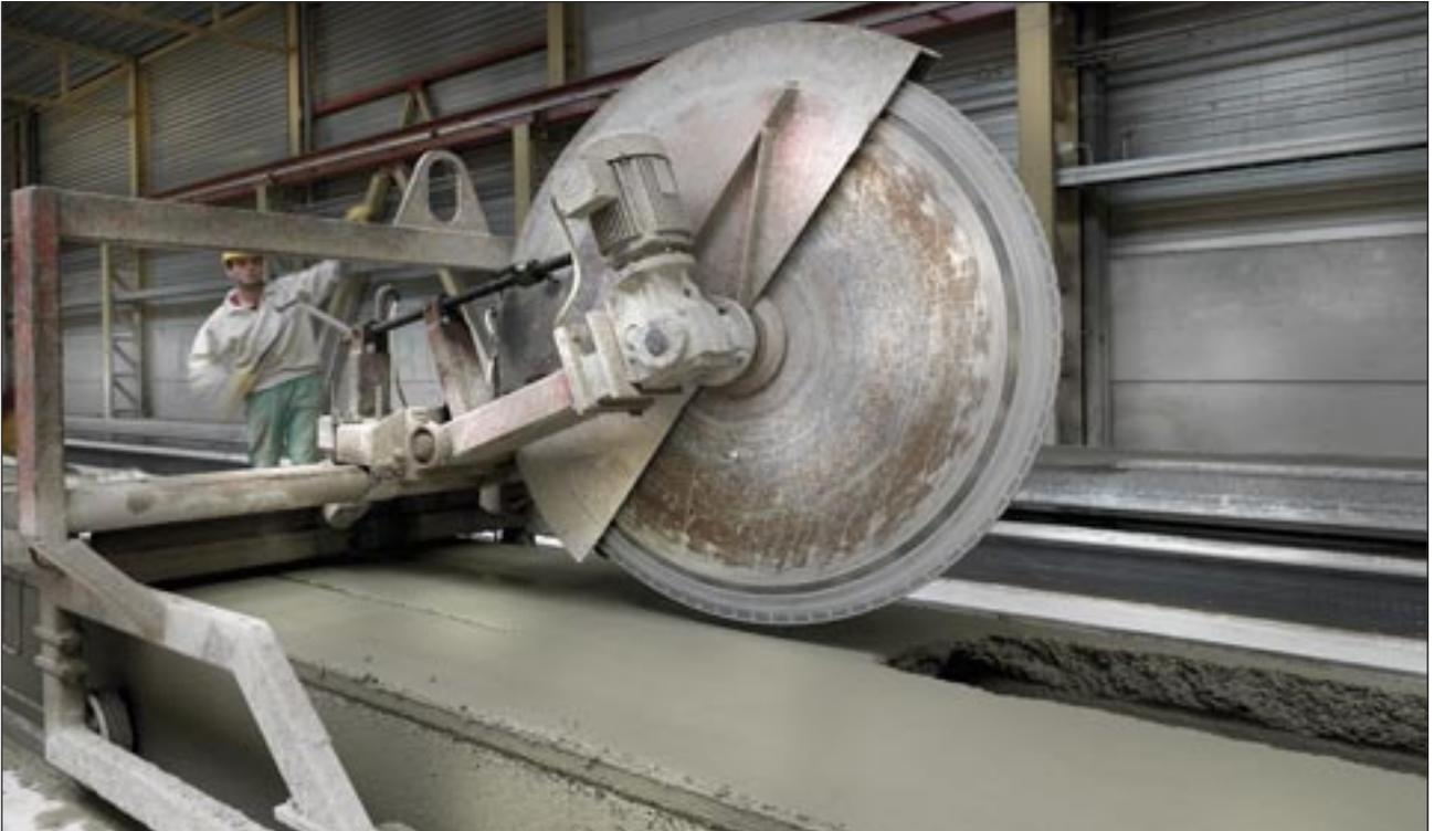
Bild 13: Die Feuchtbetonsäge bei der Herstellung von Passplatten
