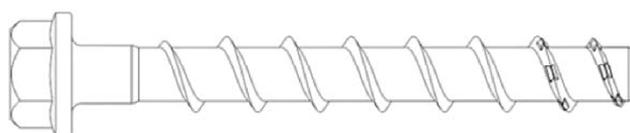
z.B. Walraven Betonschraube WCS1H, Ausführung mit Sechskantkopf und Anbauteil
