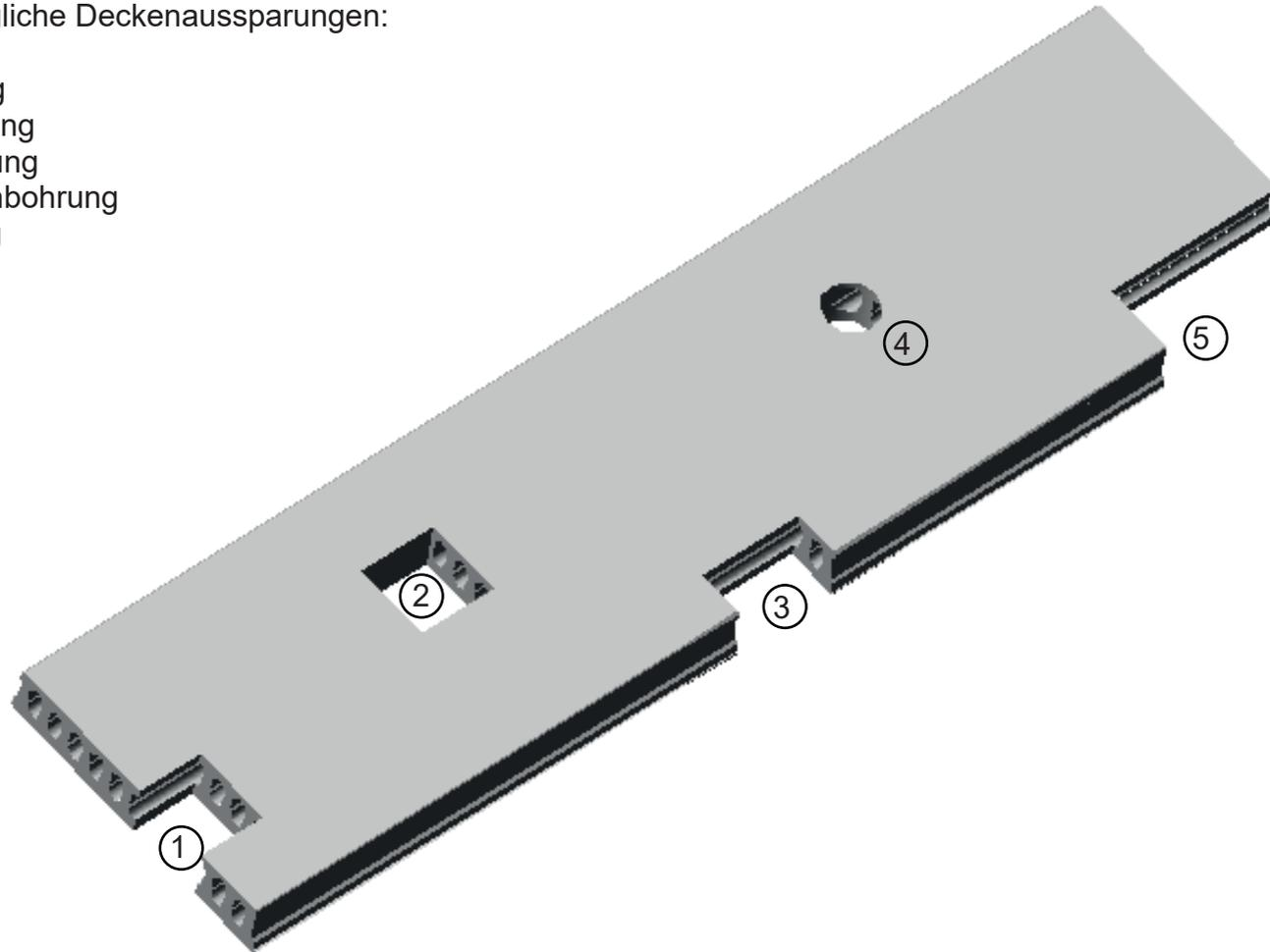
Die max. Breite der Aussparung darf  $\frac{1}{3}$  der Plattenbreite (40cm) nicht überschreiten.
